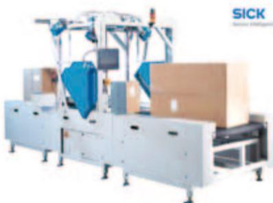
包裹、激光或光栅式体积扫描系统--测量包裹体积、称(动态或静态)-用于测量包裹重量、控制器-将长、宽、高及重量的测量数据与条码识别的数据整合,发送到上位主系统。成套的DWS,解决了扫码、测体积、重量不同子系统之间的机械、接口、匹配问题,实现了更高的识别率、可靠度及更快的投资回报。
