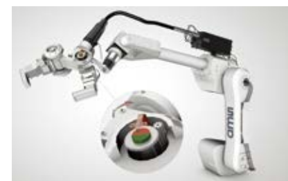
帶有磁性位置感測器的機器人手臂
