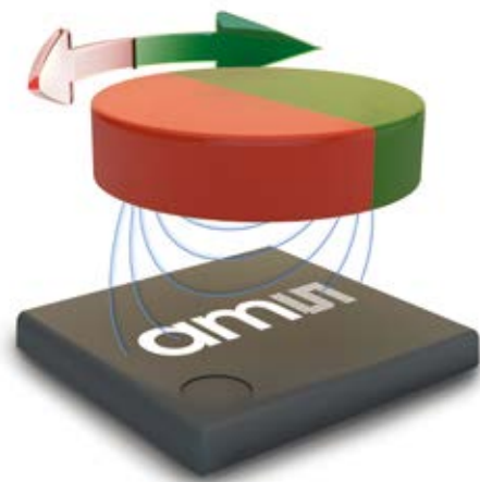
採用圓盤形磁體的磁性位置感測器
